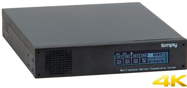
V40综合业务光传输单元体积小巧，功能全面，使用波分复用和时分复用技术，可同时传输4路12G-SDI视频、1路BB同步、1路串行数据，4路GPIO和1路千兆以太网，并可与其他Incam设备组合使用。配备OLED液晶屏，可显示每路信号的工作状态。系统既可以使用通用单模光纤也可以使用SMPTE规格的摄像机复合光缆连接，并使用复合光缆为远端设备供电。
